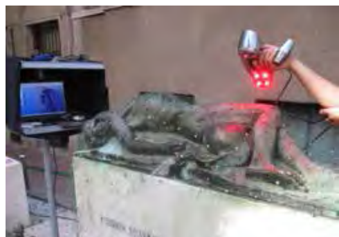
Сл. 4. и 5. 3D ласерско скенирање скулптуре покретним скенером
