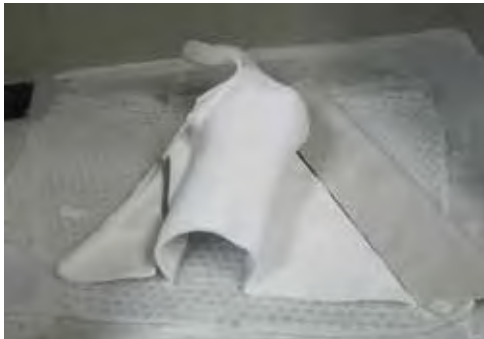
Сл. 11. и 12. Прототип недостајућег дела скулптуре, настао као резултат поступка 3D штампе
