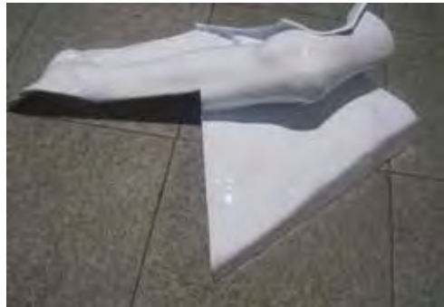
Сл. 11. и 12. Прототип недостајућег дела скулптуре, настао као резултат поступка 3D штампе
