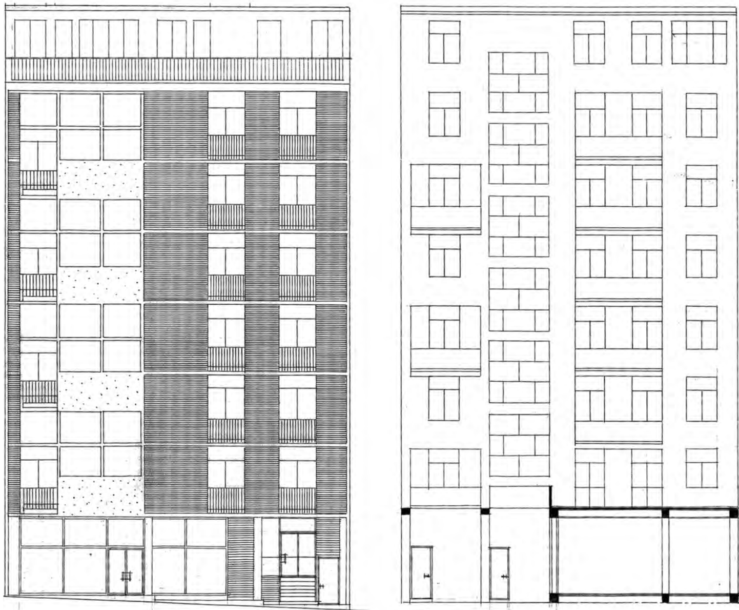
Сл. 4. Изгледи уличне и дворишне фасаде у размери 1 : 50, 1957. (Оригинална пројектна документација архитекте Мирослава – Мирка Јовановића)
